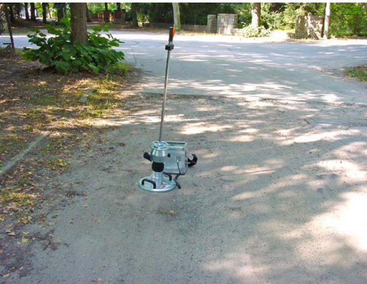
Bild 72 Tragfähigkeitsmessung mit dem Leichten Fallgewichtgerät auf einer alten sandgeschlämmten Schotter-deckschicht ( E_{vd10\%} -Quantil = 60 MN/m 2 ) / © LS
