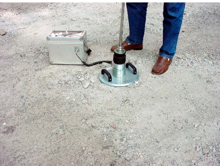
Bild 68 Bestimmung des dynamischen Verformungsmoduls E_{vd} mit dem Leichten Fallgewichtsgerät / © LS
