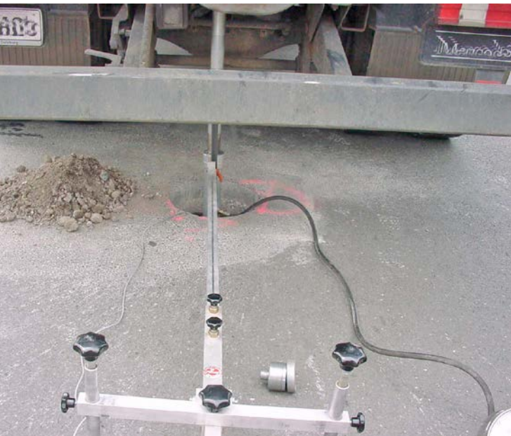
Bild 67 Bestimmung des statischen Verformungsmoduls E_{v2} im Bohrloch / © LS
