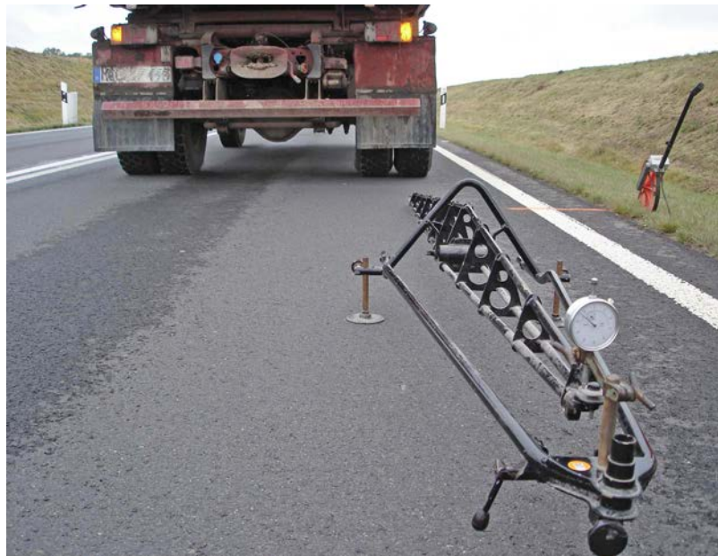
Bild 69 Einsenkungsmessungen mit dem Benkelman-Balken auf flexibler Befestigung / © LS
