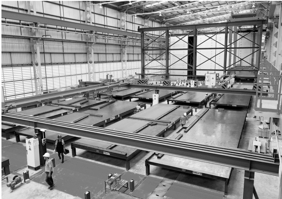
Abb. 5.3 Herstellung von Betonfertigteilen mit einer automatisierten Palettenumlaufanlage
