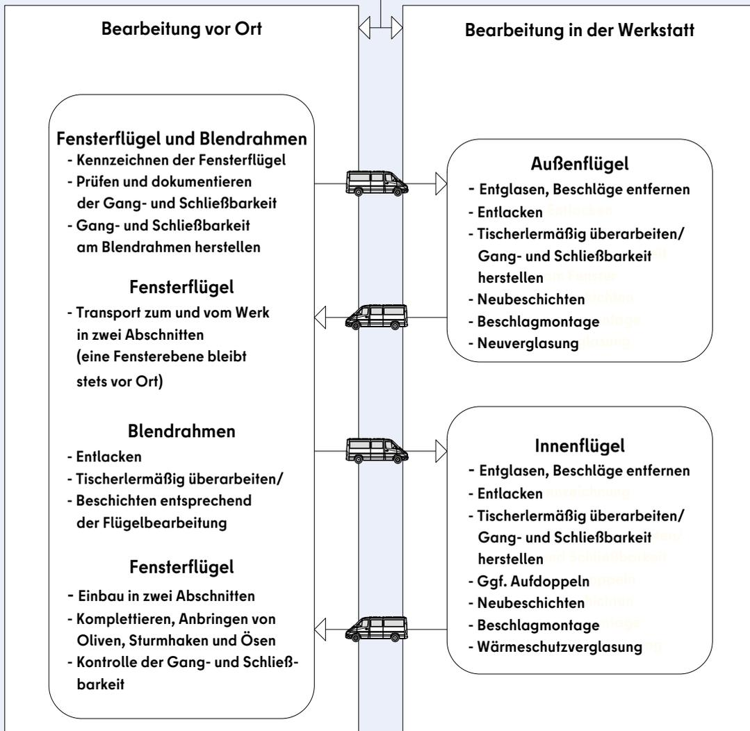
Kompakte Darstellung des idealtypischen Regelablaufs der Kastenfensterrunderneuerung mit energetischer Ertüchtigung, wie er im Leitfaden HO.09 des Verbands Fenster und Fassade (VFF) beschrieben ist. Der Leitfaden kann beim VFF gegen eine Schutzgebühr bezogen werden [↗ [Link](#)].
