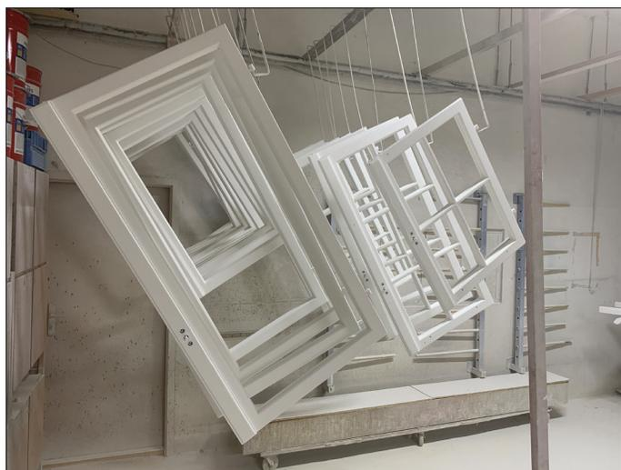
Eine komplexe Fenstersanierung, die lange halten soll, erfordert, Teile der Arbeiten in der Werkstatt durchzuführen. Beim Kastenfenster besteht im Gegensatz zu Einfachfenstern der grundsätzliche Vorteil, das stets eine funktionierende Fensterebene vor Ort bleiben kann.
